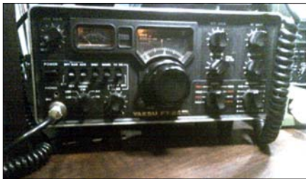
Sl. 57b. Yaesu FT-221R koji je mogao da radi CW, SSB, AM i FM (1976)
