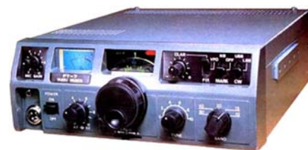
Sl. 47. Amaterski prenosni transiver Yaesu FT-7
